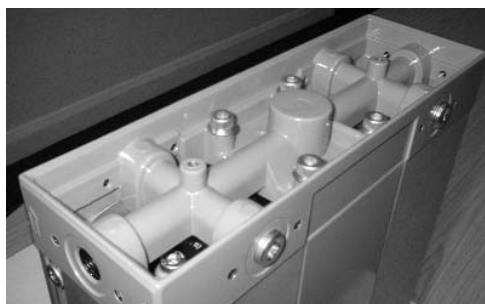
Sécheur sans son couvercle supérieur.
