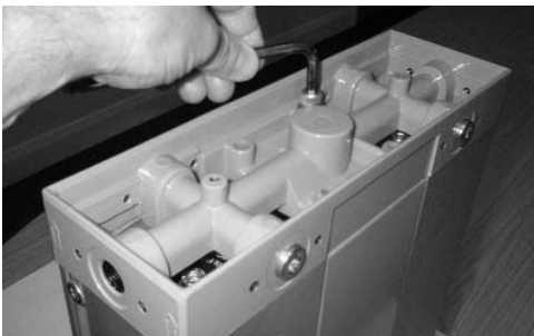
Droger met verwijderde multipoortverdeler.
