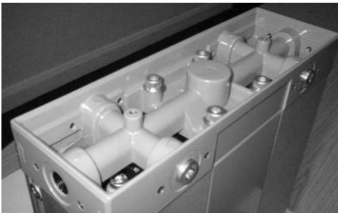
Droger met verwijderd bovenpaneel.
