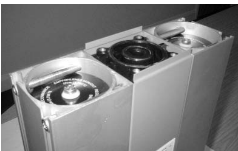
Droger met verwijderde multipoortverdeler.
