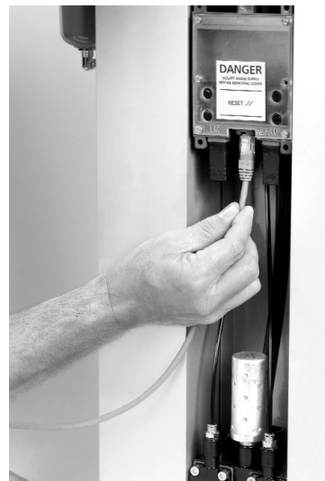
Connexion du PC à l'unité de commande
